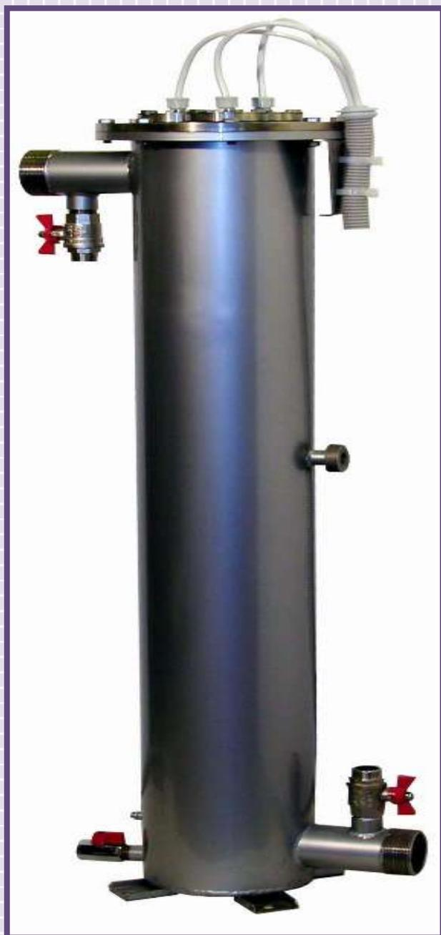
Источником лучей ультрафиолета являются ртутные лампы, находящиеся в чехле из кварцевого стекла, которые в свою очередь устанавливаются в корпусе из нержавеющей стали. Кварцевые чехлы свободно пропускают ультрафиолетовые лучи и необходимы для защиты ламп от контакта с водой. Собственно обеззараживание воды происходит при воздействии ультрафиолетового излучения на воду, протекающую внутри корпуса между кварцевыми чехлами.
